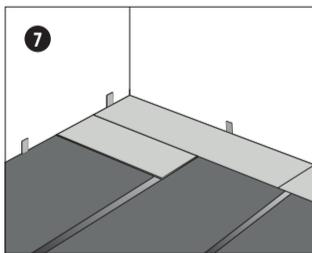
Das übrig gebliebene Stück winkeln Sie flach mit der Feder so weit wie möglich in die Längsseite der vorherigen Produktreihe ein und drücken es langsam herunter, sodass es spürbar einrastet.
