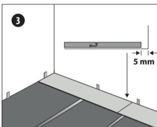
Entfernen Sie bei der ersten Produktreihe die Feder zur Wand. Lassen Sie zur Wand einen Abstand von ca. 5 mm.
