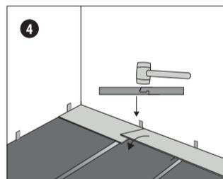
Die Produkte der ersten Reihe werden zuerst auf der kurzen Stirnseite verbunden. Es wird in einem Winkel von 30° angesetzt und eingeschwenkt. Klopfen Sie vorsichtig mit einem Gummihammer auf die stirnseitige Verbindung, sodass beide Planken einrasten und auf der gleichen Höhe sind.
