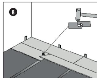
Das nächste vollständige Produkt wird wie zuvor erst längsseitig flach eingewinkelt und noch vor dem Einrasten stirnseitig dicht an das vorherige Produkt geschoben. Klopfen Sie vorsichtig mit einem Gummihammer auf die stirnseitige Verbindung, sodass beide Planken einrasten und auf der gleichen Höhe sind. Dieses Vorgehen kann für den gesamten Raum fortgeführt werden.
