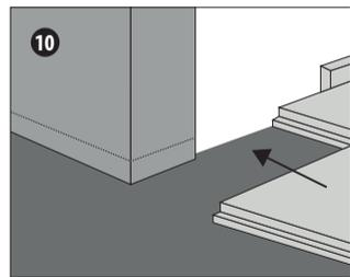
Müssen Sie einen Ausschnitt für eine Holztürzarge vornehmen, dann legen sie das Produkt gegen die Türzarge und kürzen dieses entsprechend der Höhe des Produktes. Achten Sie auch dort auf ausreichend Bewegungsfugen von ca. 5 mm.
