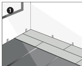
Die Empfohlene Verlegerichtung ist längs zur Hauptlichtquelle. Die größtmögliche zusammenhängende Verlegefläche beträgt 10 m in Richtung Breite und 10 m in Längsrichtung. Zu Wänden, größeren Flächen und Räumen müssen passende Bewegungsfugen berücksichtigt werden.
